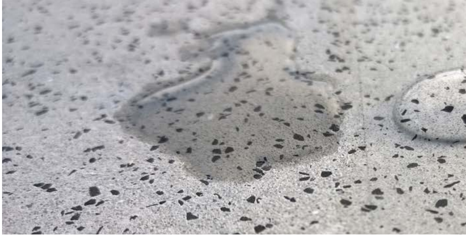
links: un behandelter Beton – Wasser dringt ein rechts: Wasser perlt ab – mit COLORTEC® MAX unsichtbar behandelter Beton
