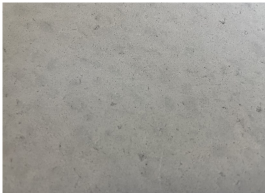
Glattgeschalter Sichtbeton der Rezeptur zum Vergleich. Smooth, form-finished surface of this mix design to compare.
