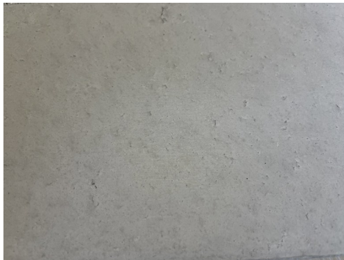
Glattgeschalter Sichtbeton der Rezeptur zum Vergleich. Smooth, form-finished surface of mix design to compare.
