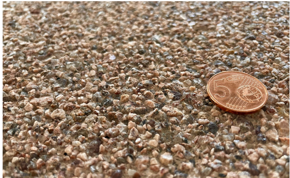
Glattgeschalter Sichtbeton der Rezeptur zum Vergleich. Smooth, form-finished surface of this mix design to compare.
